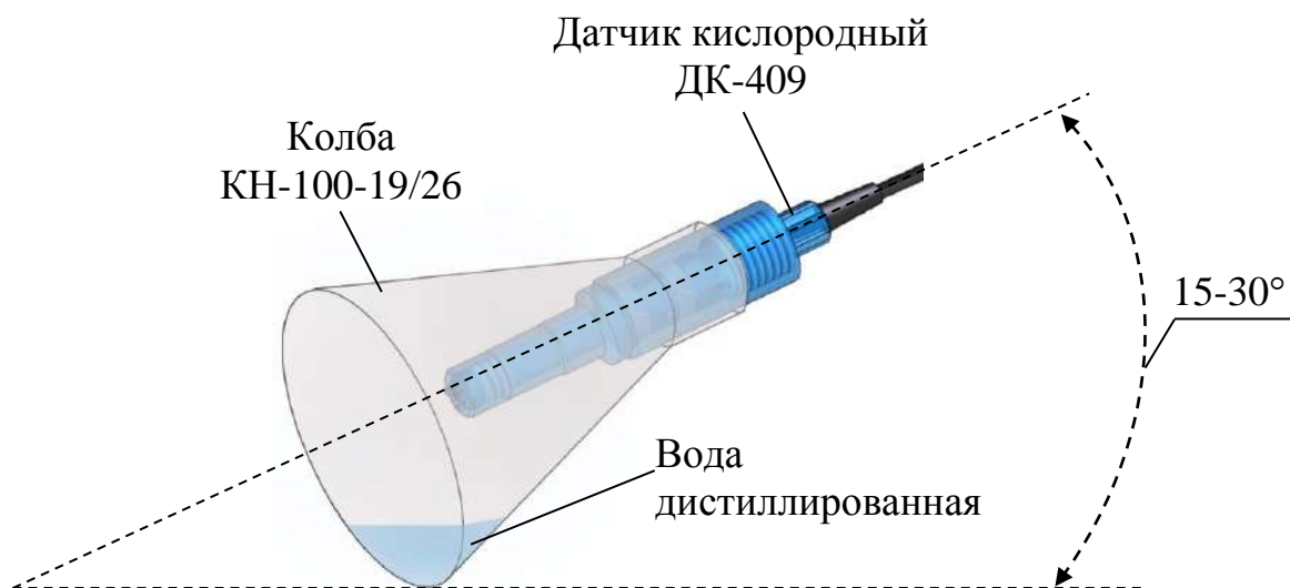
Рисунок 2.8 – Градуировка датчика ДК-409
