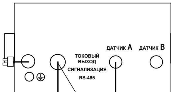
Блок преобразовательный щитового исполнения (вид сзади)
