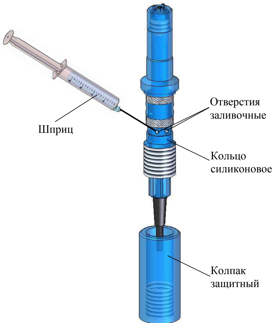
Рисунок 3.1 – Замена электролита ЭК
