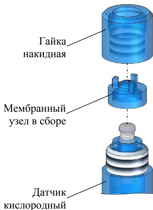
Рисунок 3.4 – Замена мембранного узла
